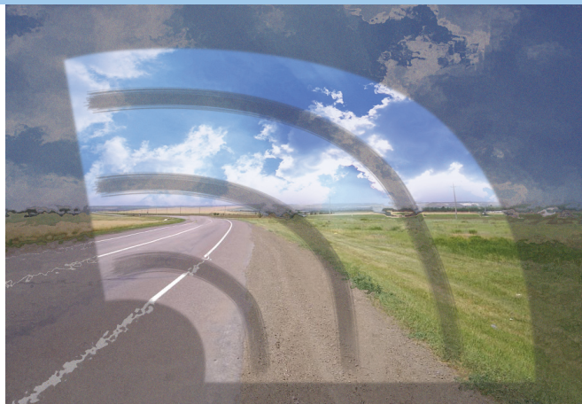
Узкие горизонтальные полосы пропуска на ветровом стекле ухудшающие видимость
