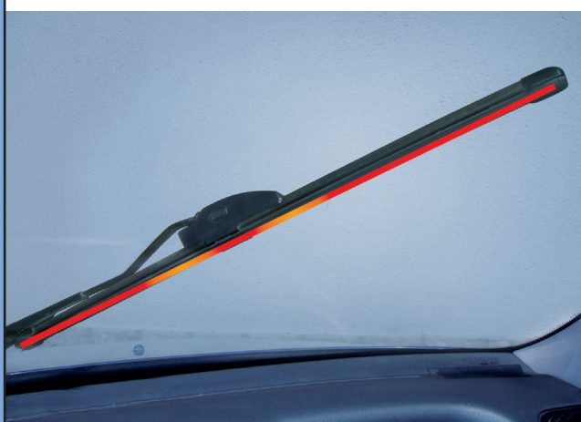
Сила прижимного давления кромки стеклоочистителя в рабочем положении, в зависимости от конструкции стеклоочистителя.
