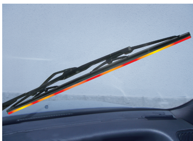
Сила прижимного давления кромки стеклоочистителя в рабочем положении, в зависимости от конструкции стеклоочистителя.
